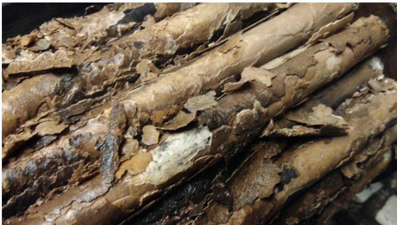
Fascio tubiero dello scambiatore di calore ricoperto da sottili strati squamosi di calcare grazie all'effetto di AquaRing®
